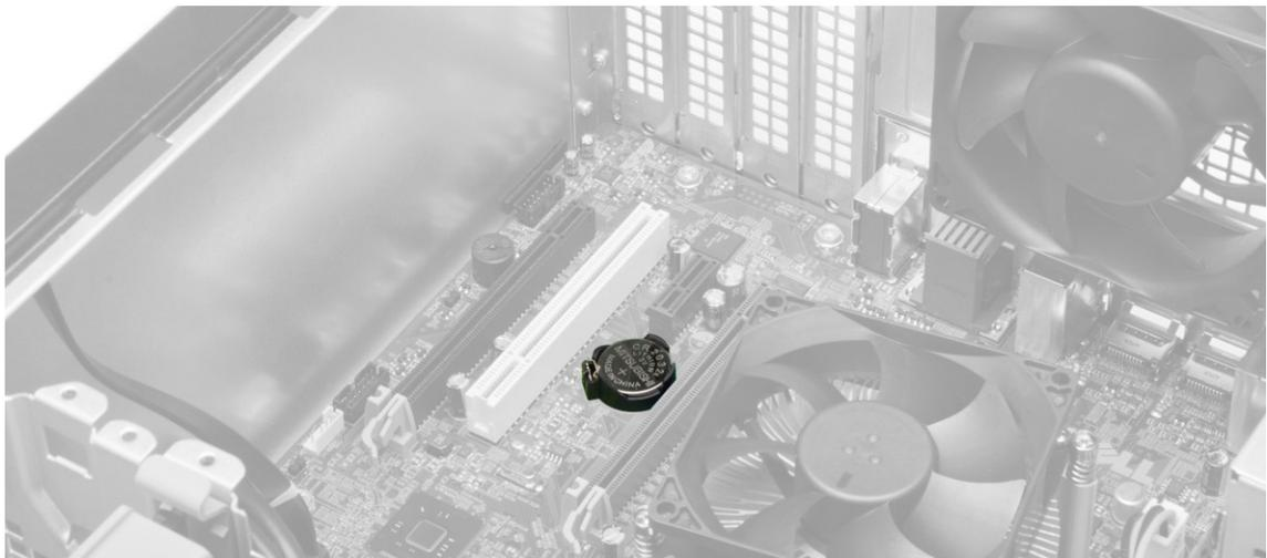
4. Presione el seguro de liberación hacia el exterior de la batería para que la batería se suelte del zócalo y extraer la batería tipo botón del equipo.
