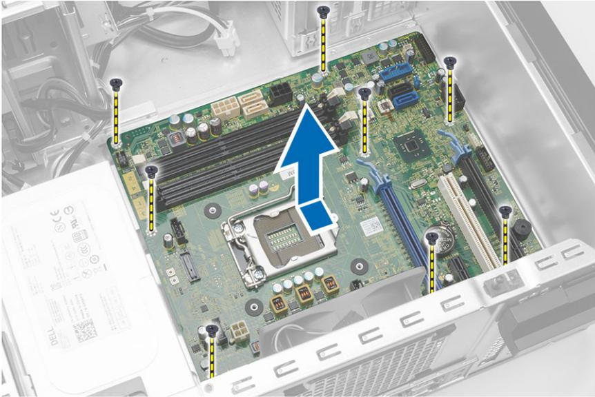
5. Incline la placa base 45 grados y después sáquela del equipo.
