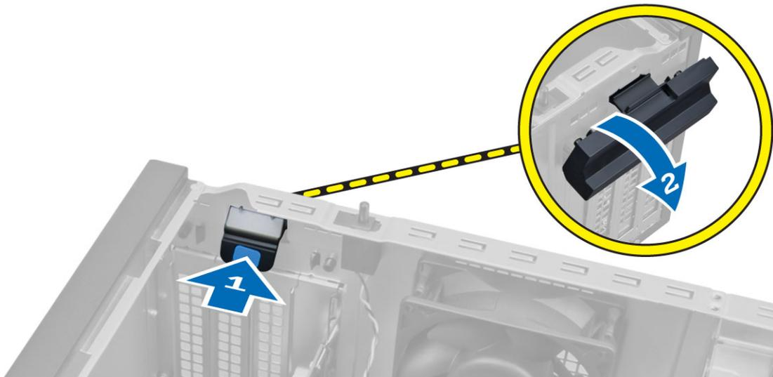
6. Tire de la palanca de liberación de la tarjeta de expansión hasta que se suelte la lengüeta de seguridad de la hendidura de la tarjeta. Después, suelte la tarjeta para sacarla de su conector y extraerla del equipo.
