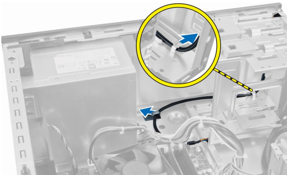
5. Presione los sujetadores ubicados a ambos lados del interruptor de encendido para soltarlo del chasis y deslícela para sacar el interruptor de alimentación junto con su cable, del equipo.
