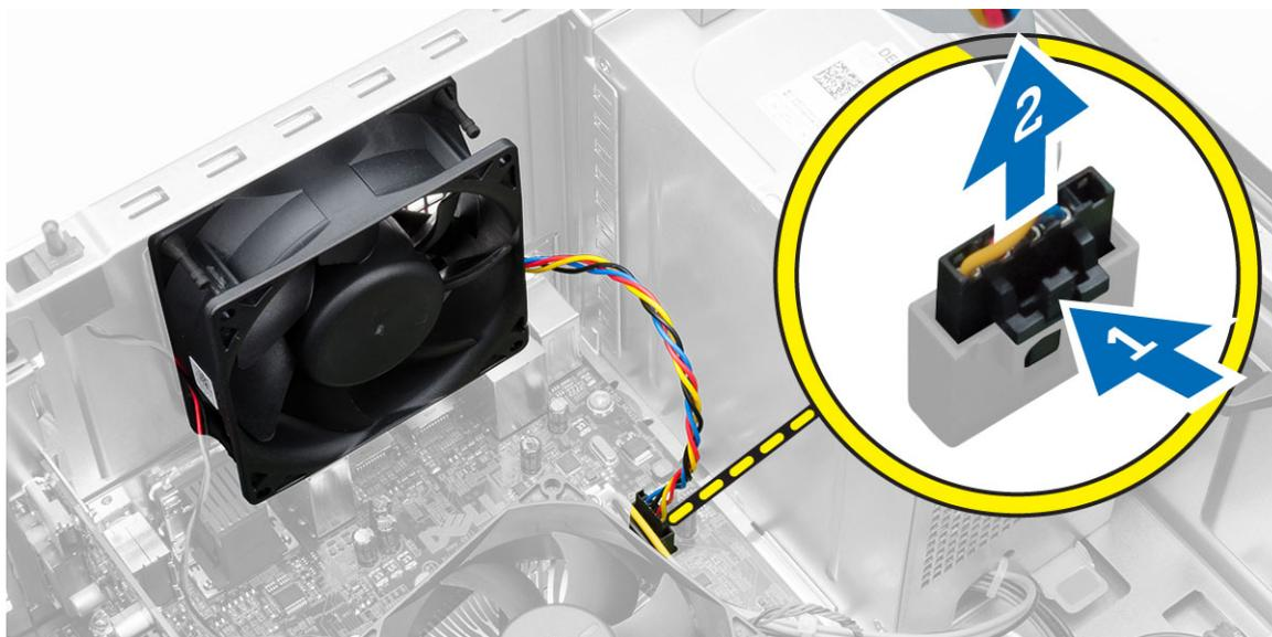
4. Haga palanca y saque el ventilador del sistema de los cuatro aros que lo sujetan a la parte posterior del equipo.
